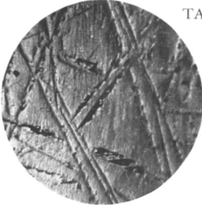
Fig. 1. Wismutbronze A mit 2.49 % Bi, unelektrolysiert.
