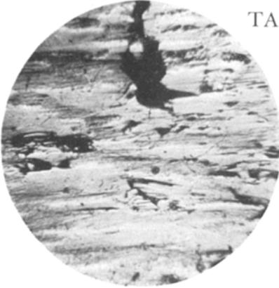
Fig. 7. Anodenstück einer ursprünglich 10.64% Bi enthaltenden Wismutbronze *B* nach Elektrolyse mit einer Stromdichte von 2.8 Amp./mm<sup>2</sup>.
